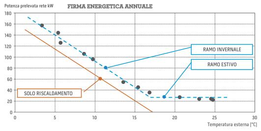
Firma energetica annuale di un impianto di riscaldamento e produzione di acqua calda sanitaria Schema dell'impianto di riscaldamento e produzione di acqua calda sanitaria
